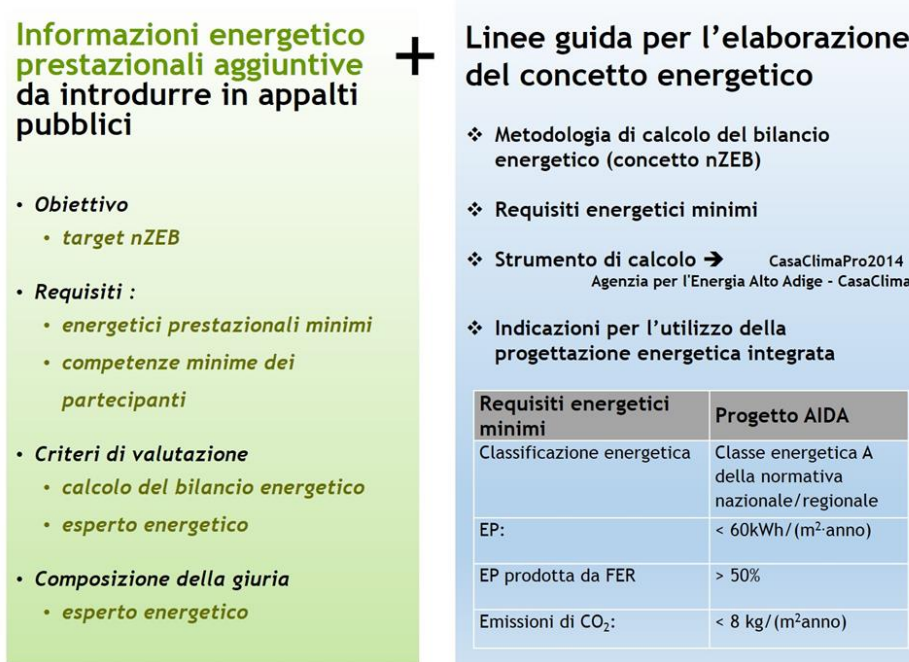
Figura 1: Schema riassuntivo delle informazioni energetico prestazionali aggiuntive e delle 'Linee guida energetiche' da introdurre in appalti pubblici. Per ulteriori informazioni, si veda il Deliverable 3.1.
